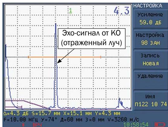
**ТИПОВЫЕ А-СКАНЫ, ПОЛУЧАЕМЫЕ ПРИ ВЫЯВЛЕНИИ ЗАРУБКИ 1×1 мм В СОП ТОЛЩИНОЙ 4,0 мм ПРЯМЫМ И ОТРАЖЕННЫМ ЛУЧАМИ ПЭП ТИПА П122-10-74-03**
