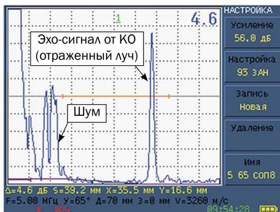
**ТИПОВЫЕ А-СКАНЫ, ПОЛУЧАЕМЫЕ ПРИ ВЫЯВЛЕНИИ ЗАРУБКИ 2×1,3 ММ В СОП ТОЛЩИНОЙ 8 ММ ПРЯМЫМ И ОТРАЖЕННЫМ ЛУЧАМИ ПЭП ТИПА П121-5-70-A1-03**
