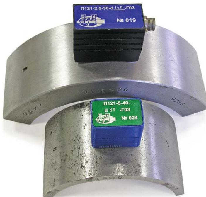
**ПРЕОБРАЗОВАТЕЛИ НАКЛОННЫЕ КОНТАКТНЫЕ СОВМЕЩЕННЫЕ ТИПА П121
