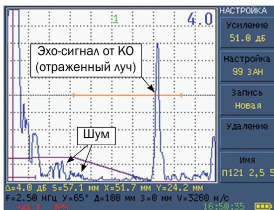
**ТИПОВЫЕ А-СКАНЫ, ПОЛУЧАЕМЫЕ ПРИ ВЫЯВЛЕНИИ ЗАРУБКИ 1,4×1 ММ В СОП Ø38×5 ПРЯМЫМ И ОТРАЖЕННЫМ ЛУЧАМИ ПЭП ТИПА П121-5-55-D38-03**
