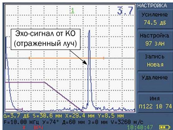
**ПРЕОБРАЗОВАТЕЛИ НАКЛОННЫЕ КОНТАКТНЫЕ СОВМЕЩЕННЫЕ
