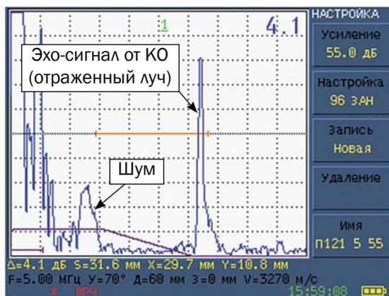
**ПРЕОБРАЗОВАТЕЛИ НАКЛОННЫЕ КОНТАКТНЫЕ РАЗДЕЛЬНО-СОВМЕЩЕННЫЕ ТИПА П121
