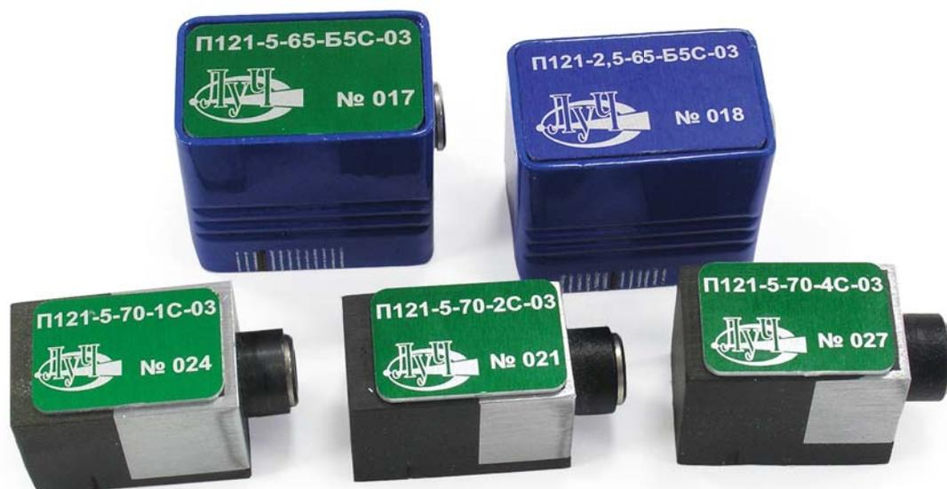
**ПРЕОБРАЗОВАТЕЛИ НАКЛОННЫЕ КОНТАКТНЫЕ СОВМЕЩЕННЫЕ
