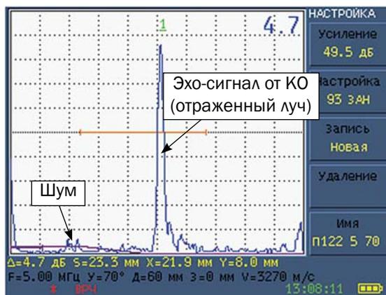
**ТИПОВЫЕ А-СКАНЫ, ПОЛУЧАЕМЫЕ ПРИ ВЫЯВЛЕНИИ ЗАРУБКИ 2×1 ММ В СОП ТОЛЩИНОЙ 8 ММ ПРЯМЫМ И ОТРАЖЕННЫМ ЛУЧАМИ ПЭП ТИПА П122-5-70-С-03**
