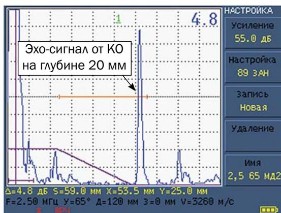
Увеличенное значение глубины залегания КО, показанное толщиномером дефектоскопа, обусловлено несколько большей скоростью поперечных волн в образце МД2-0-1 по сравнению с образцом СО-2 и, следовательно, большим углом ввода.
