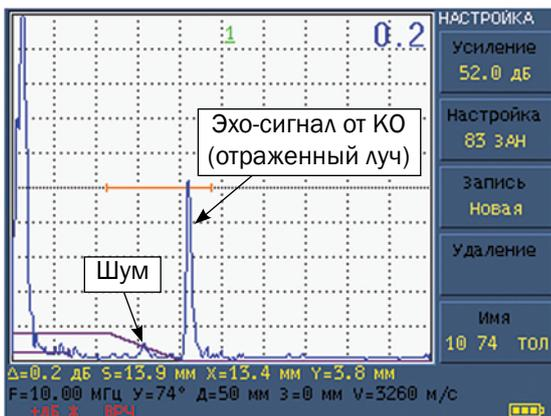
**ПРЕОБРАЗОВАТЕЛИ НАКЛОННЫЕ КОНТАКТНЫЕ СОВМЕЩЕННЫЕ
