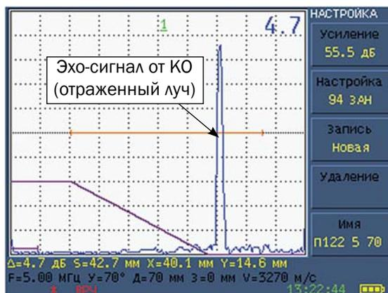
**ТИПОВЫЕ А-СКАНЫ, ПОЛУЧАЕМЫЕ ПРИ ВЫЯВЛЕНИИ ЗАРУБКИ 1×0,65 мм В СОП ТОЛЩИНОЙ 2,1 мм ПРЯМЫМ И ОТРАЖЕННЫМ ЛУЧАМИ ПЭП ТИПА П122-10-74-03**
