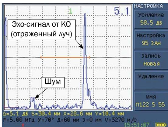
**ТИПОВЫЕ А-СКАНЫ, ПОЛУЧАЕМЫЕ ПРИ ВЫЯВЛЕНИИ ЗАРУБКИ 1×0,8 ММ
