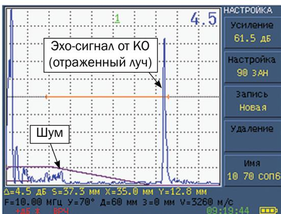
**ТИПОВЫЕ А-СКАНЫ, ПОЛУЧАЕМЫЕ ПРИ ВЫЯВЛЕНИИ ЗАРУБКИ 1×0,65 ММ В СОП ТОЛЩИНОЙ 2,1 ММ ПРЯМЫМ И ОТРАЖЕННЫМ ЛУЧАМИ ПЭП ТИПА П121-10-74-А1-03**
