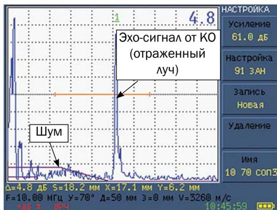
**ТИПОВЫЕ А-СКАНЫ, ПОЛУЧАЕМЫЕ ПРИ ВЫЯВЛЕНИИ ЗАРУБКИ 1×0,65 ММ В СОП ТОЛЩИНОЙ 6 ММ ПРЯМЫМ И ОТРАЖЕННЫМ ЛУЧАМИ ПЭП ТИПА П121-10-70-А1-03**
